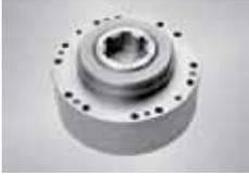
QJM 型液压马达与各种油泵、阀及液压件组成液压传动装置，由于它在设计上采取了一定措施，故可适应各种机器工况。该型马达具有重量轻、体积小、调速范围大，可有级变量、工作可靠、寿命长等优点，目前已应用于矿山工程、起重运输、冶金、船舶、机床、塑料加工、地质勘探等领域。主要用在履带行走、轨道轮子驱动、各种回转机构、勘探钻孔、绞车提升、皮带运输传动、物料搅拌、路面切割、船舶推进、塑料注射等部位。
